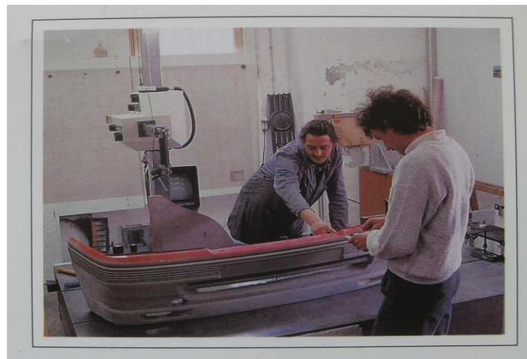
Martin Hofele kontrolliert das 1:1-Modell einer Frontstoßstange an der Meßmaschine
