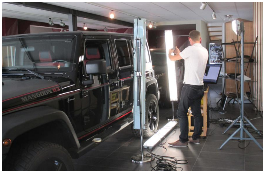
Nächster Schritt: Scannen der Autokarosserie, als Basisdaten für das CAD-Engineering
